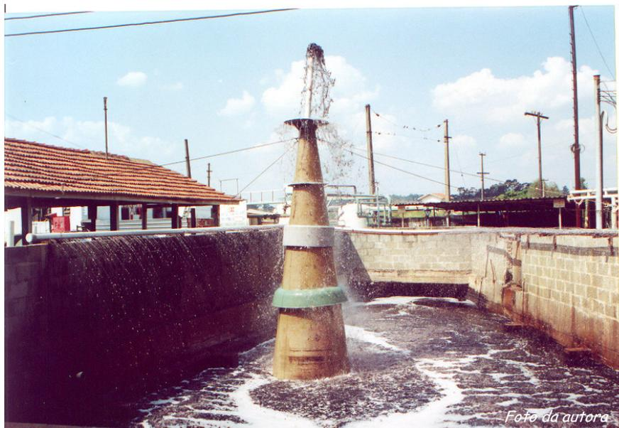
Ao término do tingimento, a tinta utilizada em alta temperatura passa pelo processo de resfriamento.
